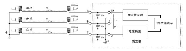
黒相の抵抗を測定する場合、A - B間のしゃへい層に直流電流を流しA - G 1間の電圧降下をA - C間で検出して抵抗値を表示します。しゃへい層断線時もコンデンサ経由 G 2 で設置される為、安全です。
