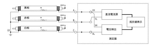
黒相の抵抗を測定する場合、A-B間のしゃへい層に直流電流を流しA-G1間の電圧降下をA-C間で検出して抵抗値を表示します。
